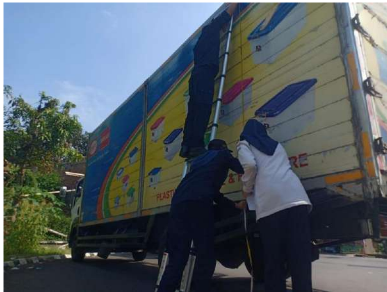
Gambar III.8 Pengukuran Dimensi Kendaraan
