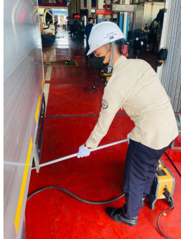
Gambar IV. 6 Pengujian Smoke Tester dan CO/HC
