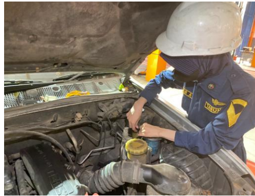
Gambar IV. 8 Melepas saluran bahan bakar
