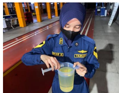
Gambar IV. 4 Pencampuran Pertamina Dex dan minyak sereh wangi
