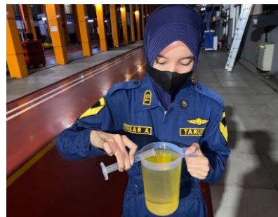
Gambar IV. 3 Pencampuran Dexlite dan minyak sereh wangi
