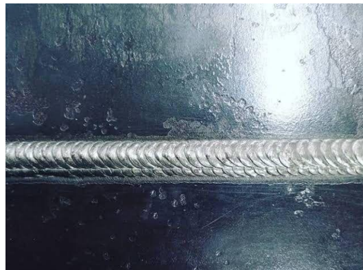
Gambar V. 1 Pengelasan sambungan plat sejajar
