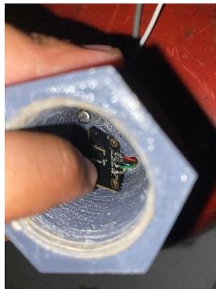
**Gambar IV.5** Perakitan Sensor AHT 20
