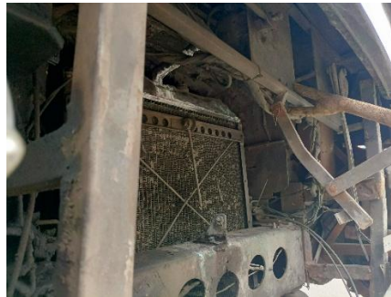
Gambar II.7 Korosi Pada Komponen Kendaraan (Dokumentasi Penulis)
