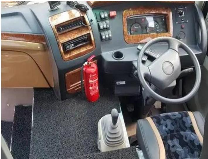
**Gambar II. 6** Posisi penempatan APAR
