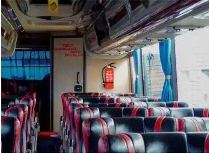
**Gambar II. 5** Posisi penempatan APAR
