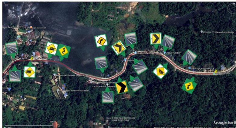
Gambar V. 2 Saran Pemasangan Rambu Sta 1+000-2+000
