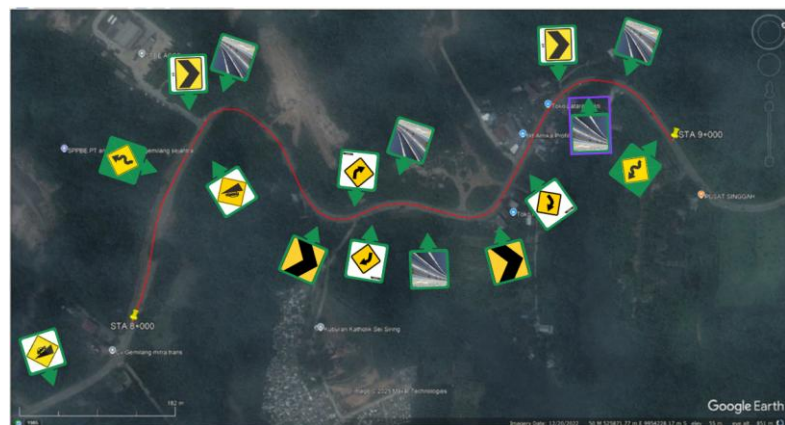
Gambar V. 5 Saran Pemasangan Rambu Sta 1+000-2+000
