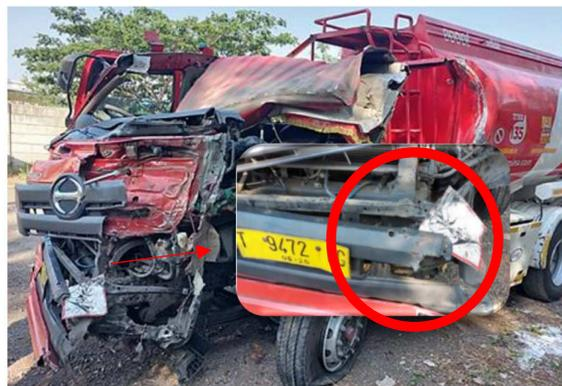
**Gambar I. 5** Plat besi dudukan fiber bumper terdeformasi (KNKT, 2023)
