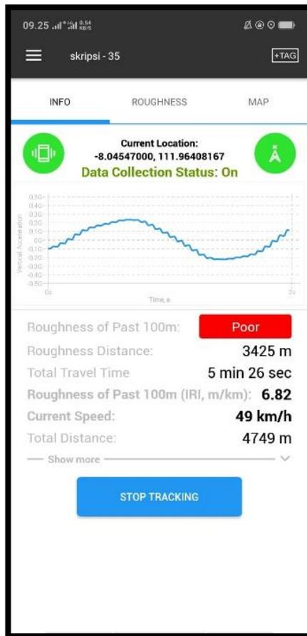
**Gambar I. 7** Pengukuran RoadLab Pro
