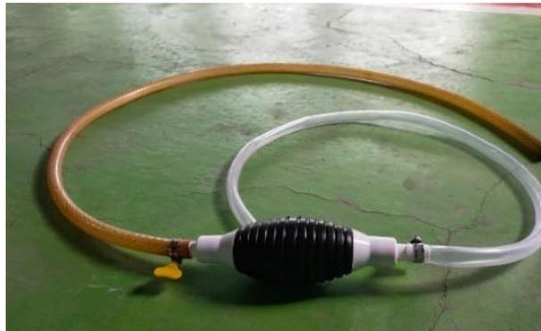
**Gambar III 10** Selang Pompa BBM
