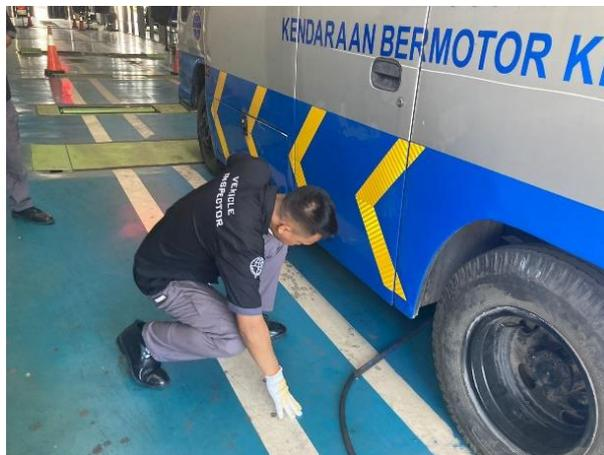
**Gambar IV. 5** Pengujian emisi gas buang
