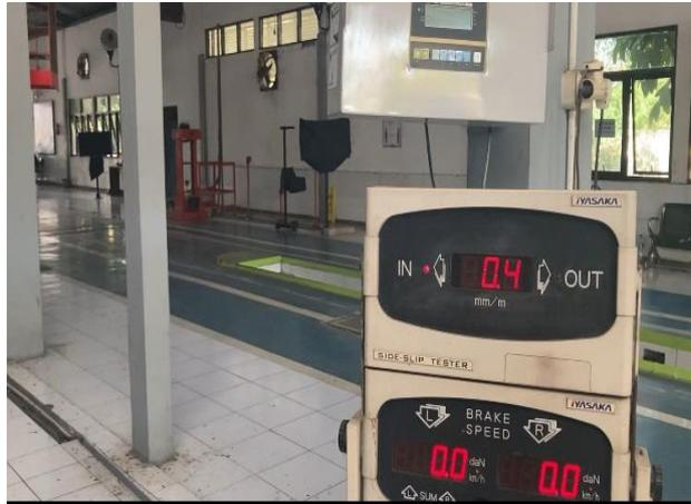
**Gambar IV. 6** Pengujian Side Slip
