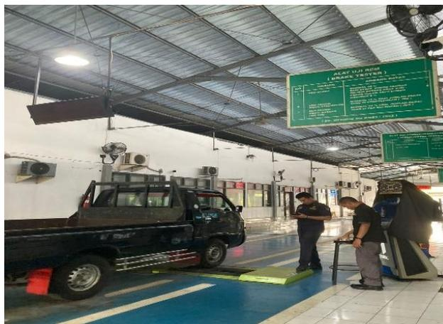
**Gambar IV. 7** Pengujian Brake Tester
