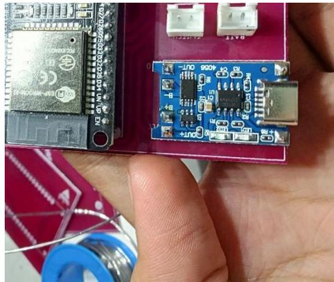
**Gambar IV. 10** Perakitan modul charger battery
