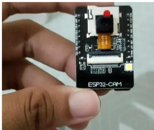
**Gambar IV. 11** Perakitan ESP32-CAM
