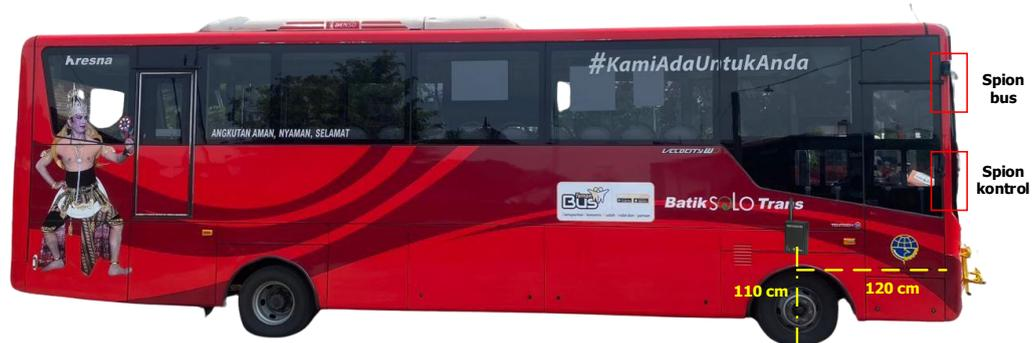
**Gambar IV. 21** Penempatan sensor pada sisi kendaraan
