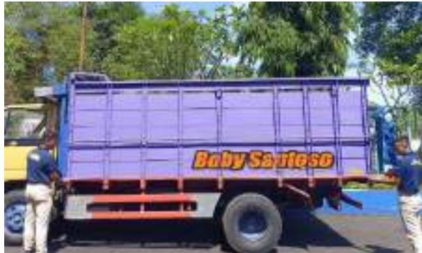
**Gambar IV.18** Pengukuran Panjang Bak Muatan
