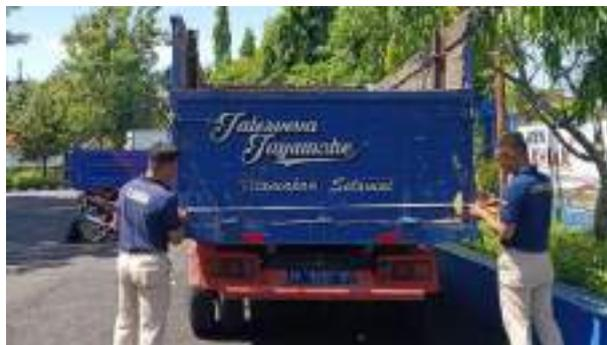
**Gambar IV. 19** Pengukuran Lebar Bak Muatan
