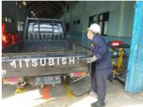
**Gambar IV.23** Pengujian Emisi Gas Buang
