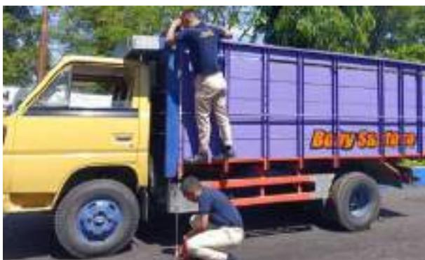
**Gambar IV.14** Pengukuran Tinggi Total Kendaraan
